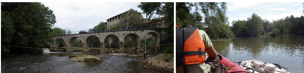
Profil en travers du Dadou et bathymétrie en canoë avec le doppler (photos : EauCéa)
